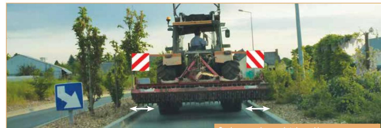
Le mobilier urbain doit être implanté suffisamment **en retrait du bord de chaussée** pour permettre le passage des matériels agricoles larges ou déportés. Ce retrait peut être également géré sur la chaussée en traitant une surlargeur de manière différenciée (couleur, matériaux). Lorsque le mobilier urbain est installé de part et d'autre de la voie, opter pour un positionnement en décalé.
